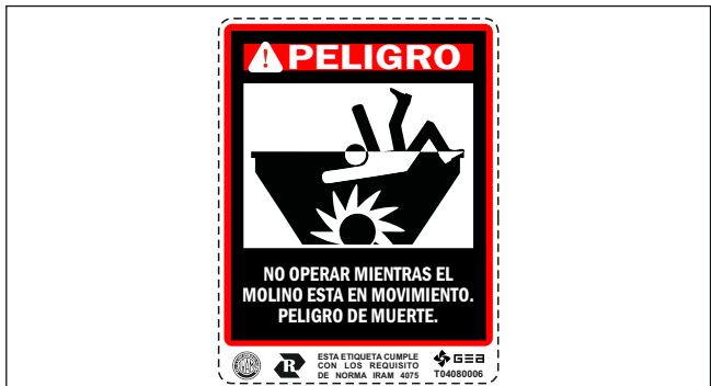
Figura 4.5: No ingresar a la tolva cuando el equipo esté en marcha.
