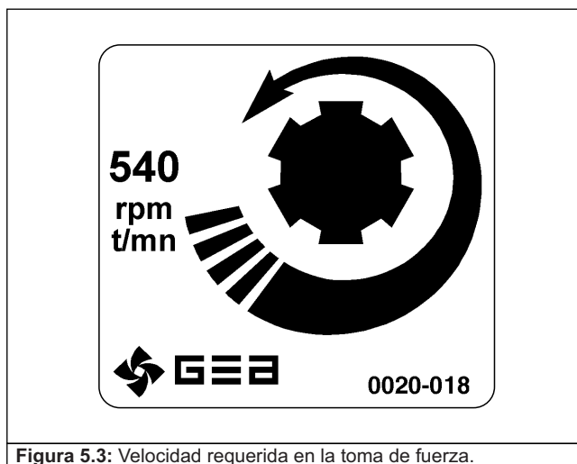
Figura 5.3: Velocidad requerida en la toma de fuerza.
