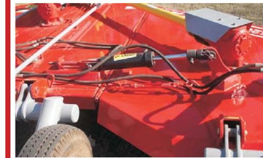
▲ Los cilindros de las alas tienen la posibilidad de moverse en su anclaje y están amortiguados. Con esto se evitan fatigas y se pueden absorber desniveles de 350mm.
