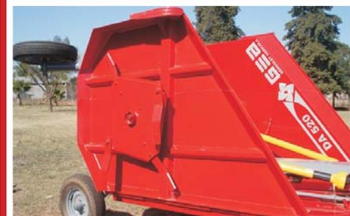
◀ Sistema hidráulico compensado que brinda un desmalezado de altura pareja por todo el ancho de corte. Además posee dos barras con resortes reforzados, que conectadas a la lanza, permiten nivelar el corte y otorgan suavidad en el andar de la máquina.
